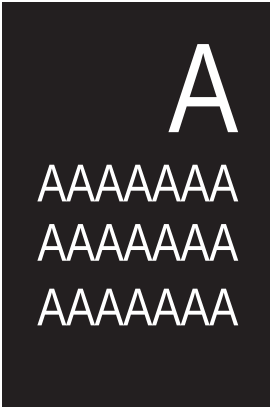
Schéma informační tabule správce Pražské tržnice kovová deska o velikosti 400x600 mm, kotvená na fasádu skytým kováním
